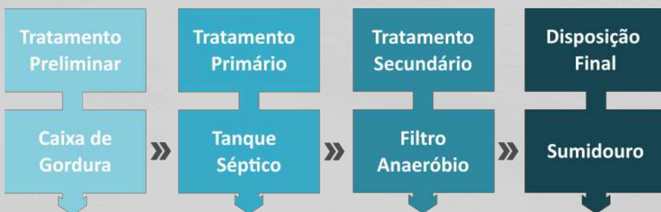
Figura 2: Sistema de tratamento proposto para o Eixo 3 - Esgotamento Sanitário: solução em lote.
