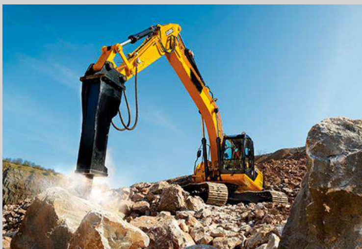
Figura 20: Escavadeira hidráulica com martelo hidráulico.
